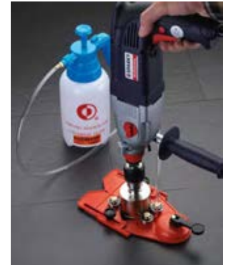
Sist. de refrigeración con depósito de agua y conexión a guía de ventosa. / Cooling system with water deposit and connection to guide with sucker.
